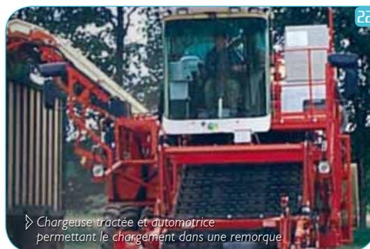
▷ Chargeuse tractée et automotrice permettant le chargement dans une remorque
