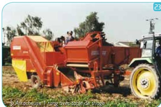
▷ Arracheuse 1 rang avec table de triage
